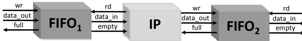
Figura 6.3: Protocolo de conexão de IPs através do uso de FIFOs.
