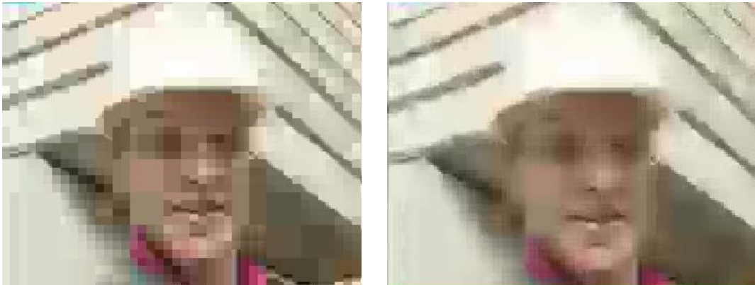
Figura 4.11: Saída do Filtro de Deblockagem para um quadro da sequência FOREMAN_QCIF, codificada como Intra.
