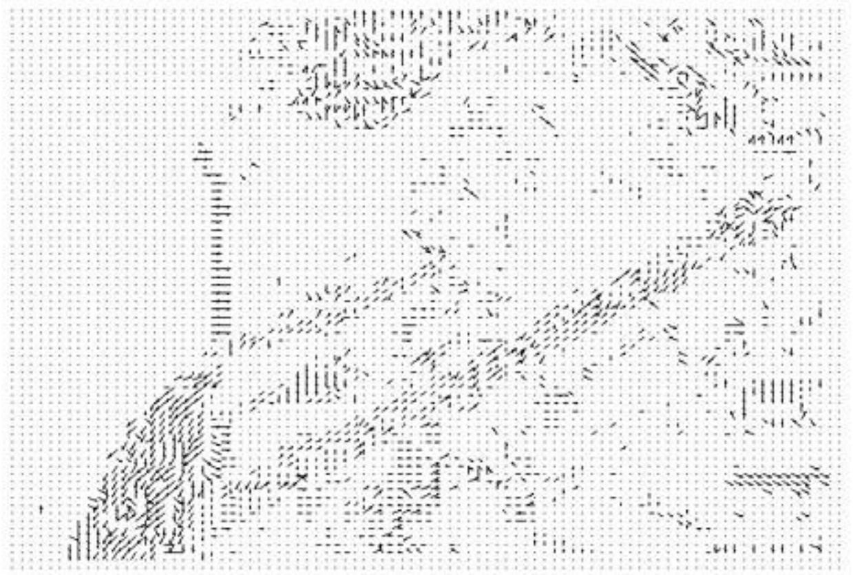
**Figura 10 - Vetores de Movimento usados na previsão temporal da figura 7 [8]**
