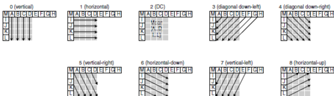
Figura 8: Representação dos modos de predição Intra 4x4 [2]
