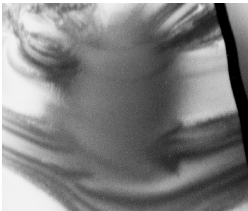
Figura 3.4 – Imagem de transmissão eletrônica de amostra de Zr_2Ni na orientação [001]. Topo: amostra virgem; embaixo: após irradiação de 4 \cdot 10^{15} elétrons/cm 2 a 900 keV e temperatura de 210 K.
