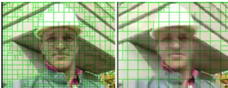
Figura 13: Divisão da imagem para estimativa de movimento com e sem particionamento
