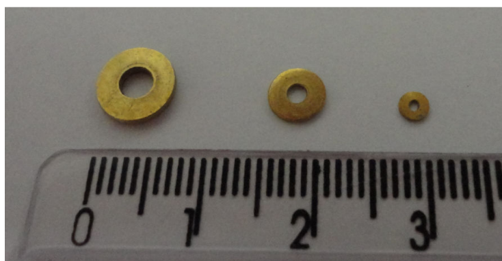
Figura 46 – Anéis de atrito após a compressão com régua milimetrada.
