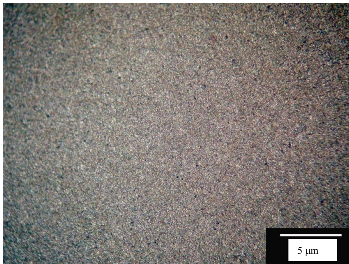
Figura 43 - Seção transversal do Alumínio AA6531, ataque reagente de Keller.
