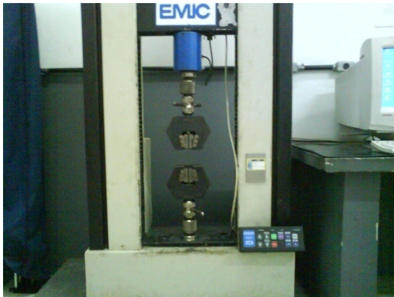
Figura 27 - Máquina de ensaios universais.
