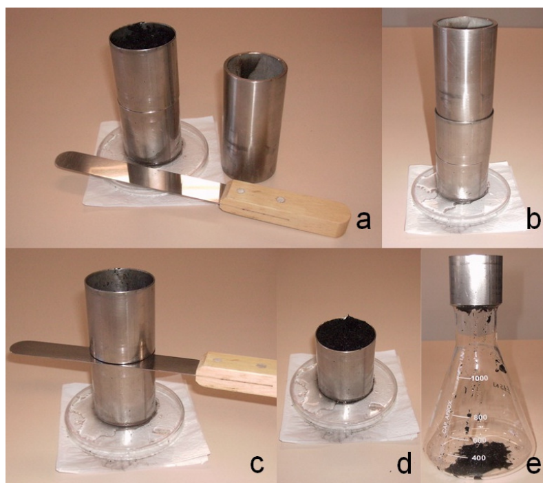
FIGURA 3. Sequência de etapas para padronização de umidade utilizadas no método de extração aquosa 1:1,5 (v/v). Preenchimento dos cilindros com substrato (a); colocação do peso (b); separação dos cilindros (c); cilindro inferior preenchido com 100 cm 3 de substrato (d); transferência para o Erlenmeyer (e). Porto Alegre, RS. 2012.
