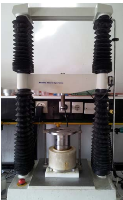
Figura 6.1 – Fotografia do equipamento utilizado para prensagem das sementes de gergelim.
