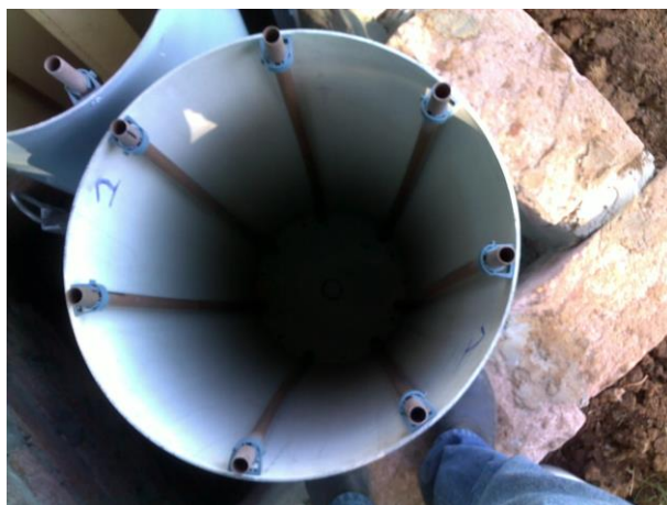
Figura 19: Tubulações de PVC de 20mm utilizados para simular o fluxo do lençol freático
