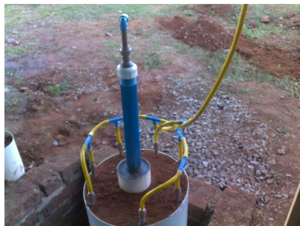
Figura 20: Perfil de solo e poço de sucção utilizado nos ensaios e mangueiras de alimentação da água contaminada.
