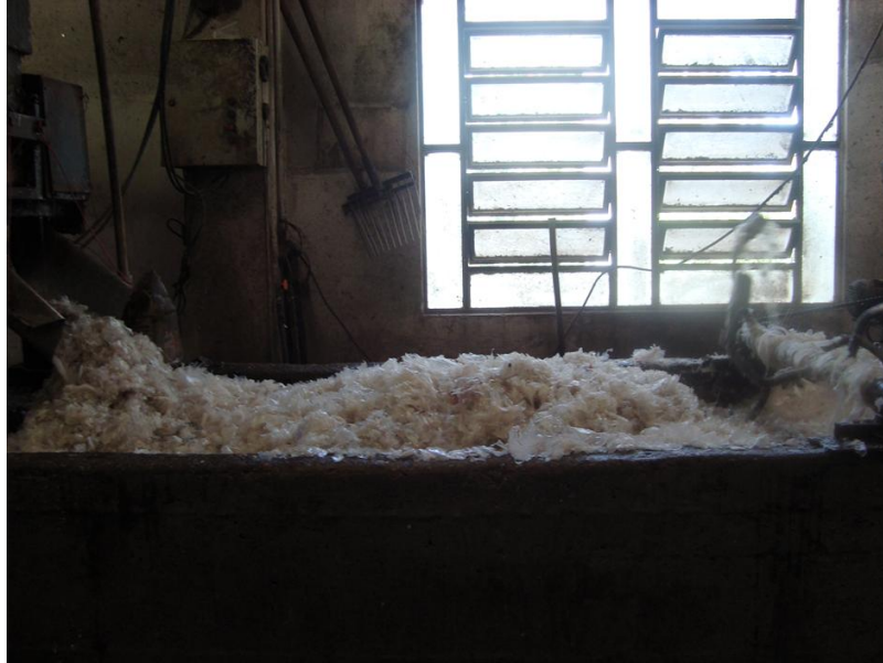
Figura 4.5: Tanque do processo de reciclagem mecânica. À direita encontra-se o primeiro moinho e à esquerda o batedor.
