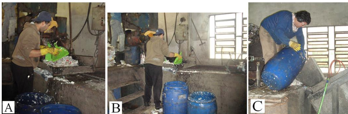
Figura 4.7: (A) Recolhimento do material saído do moinho pela peneira, (B) Vista geral do transporte da peneira para os tambores e (C) Descarregamento do material no secador.
