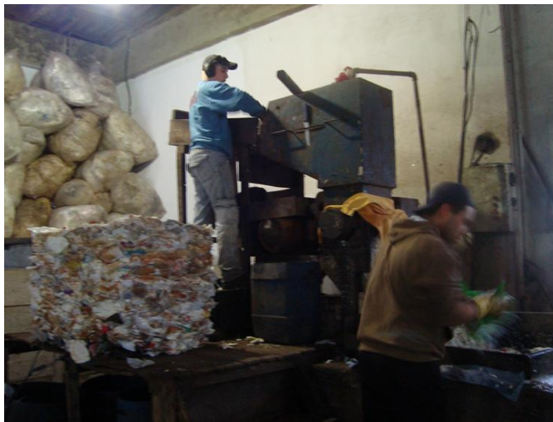
Figura 4.4: Alimentação manual do moinho de facas.
