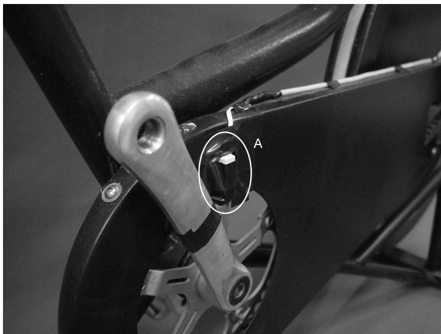
Figura 14 – Sensor eletromagnético. A indica um ímã fixado no cicloergômetro (vista frontal).
