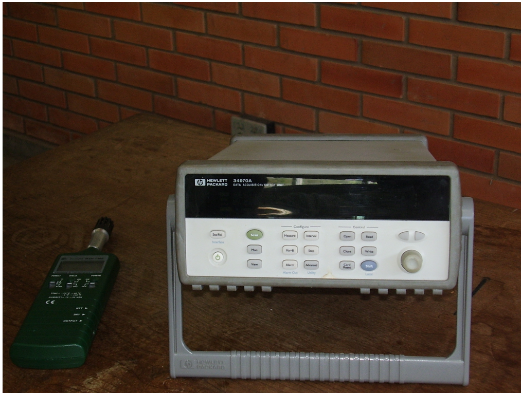
Figura G1. Unidade Agilent 34970A .
