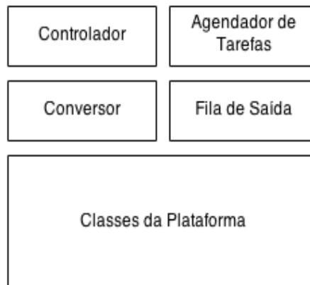
*Figura 17: Composição genérica de um módulo de integração*
