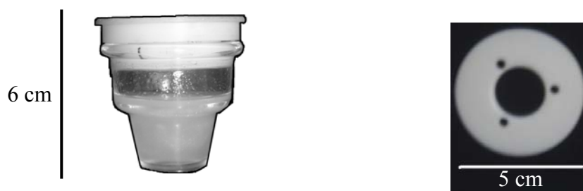
Figura 3.2. Célula utilizada para os testes iniciais de eletrólise da água.
