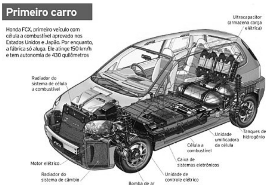
Figura 4.2. Honda FCX movido com um sistema de células a combustível [11].
