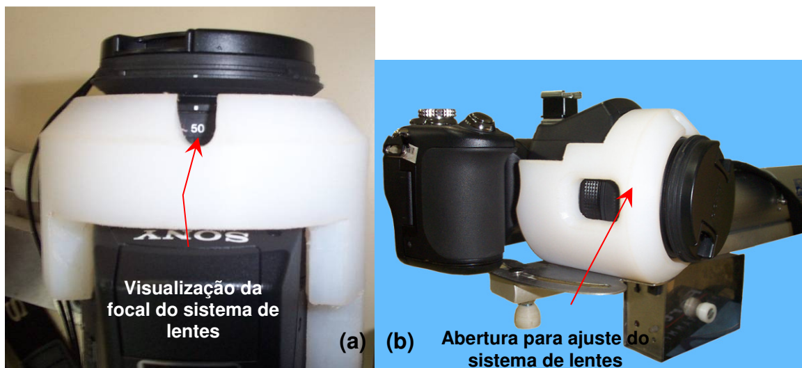
Figura A-8 – Ajuste do sistema de lentes: (a) visualização do sistema do ajuste do sistema de lentes; (b) abertura para ajuste do sistema de lentes.
