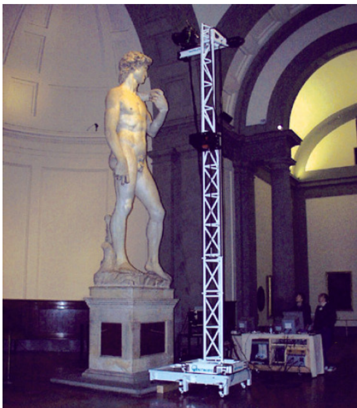
Figura 2-13 – Sistema usando varredura em linha e o princípio da triangulação. Fonte: Levoy et al (2000).
