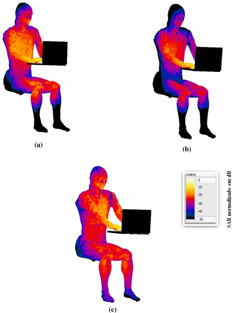
Figura 30 Distribuição da SAR no modelo com a PIFA na tela afastando se do torso: (a) vista em perspectiva inicial a 22 cm (b) vista em perspectiva intermediária a 32 cm e (c) vista em perspectiva final a 42 cm.
