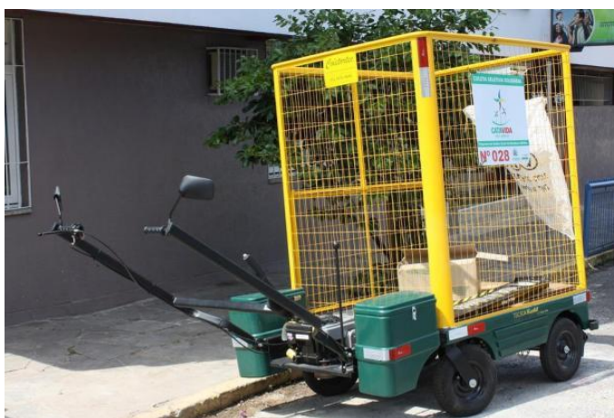
Figura 10. Carrinho elétrico para coleta seletiva no município de Novo Hamburgo, Rio Grande do Sul Fonte: Zero Hora, 2013
