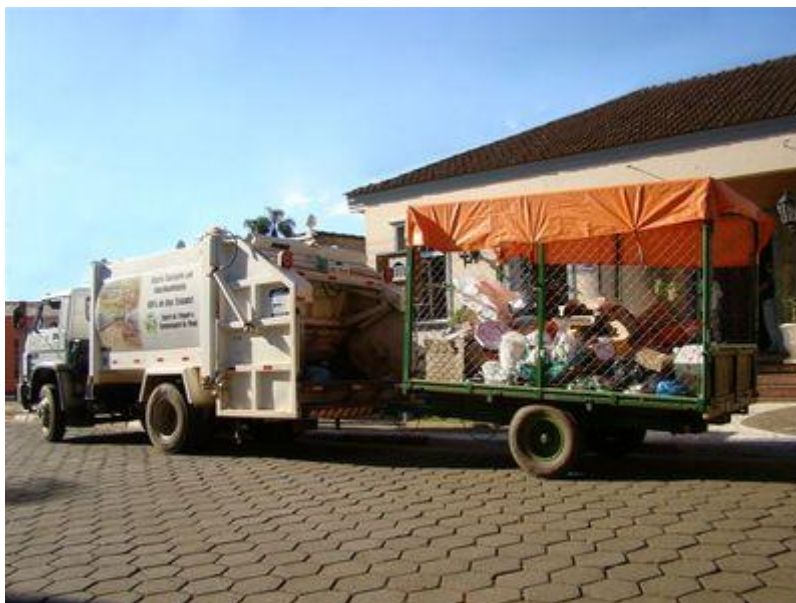
Figura 9. Caçamba para coleta seletiva, acoplado ao caminhão de coleta normal Fonte: Camargo, 2011
