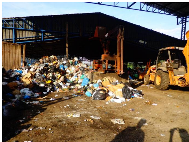
Figura 32. Área de descarregamento do resíduo e retroescavadeira utilizada para levar o material até a esteira Data: 02/08/13. Fonte: Acervo autora
