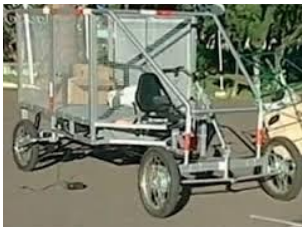
Figura 11. Adaptação de bicicleta à gaiola para coleta de recicláveis, do projeto "Cavalo de lata" Fonte: G1 RS, 2013
