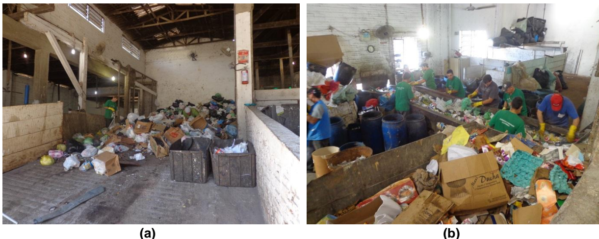
Figura 27. Central de triagem de Picada Verão - Dois Irmãos/RS. (a) Rampa e plataforma de descarregamento de material e (b) matérias volumosos previamente removidos e esteira de triagem
