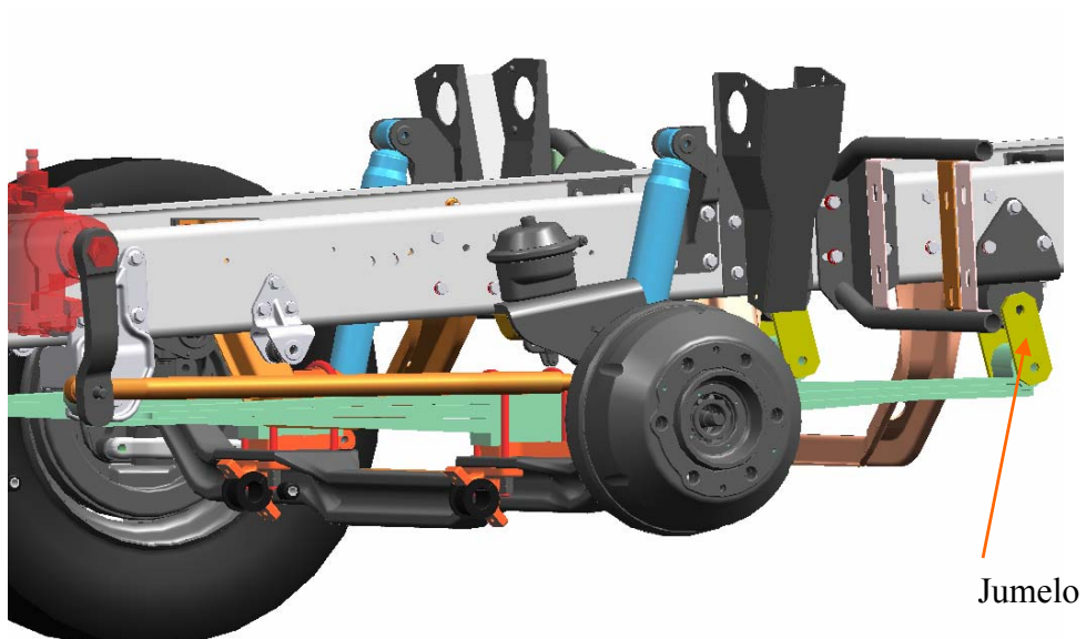
Figura 2.9 – Suspensão de molas semi-elípticas com laminas paralelas (Fonte: Projeto restrito de identificação)
