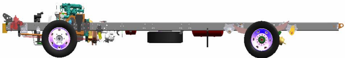
Figura 2.4 – Veículo com motor posicionado sobre eixo dianteiro e com tração traseira (Fonte: Projeto restrito de identificação)
