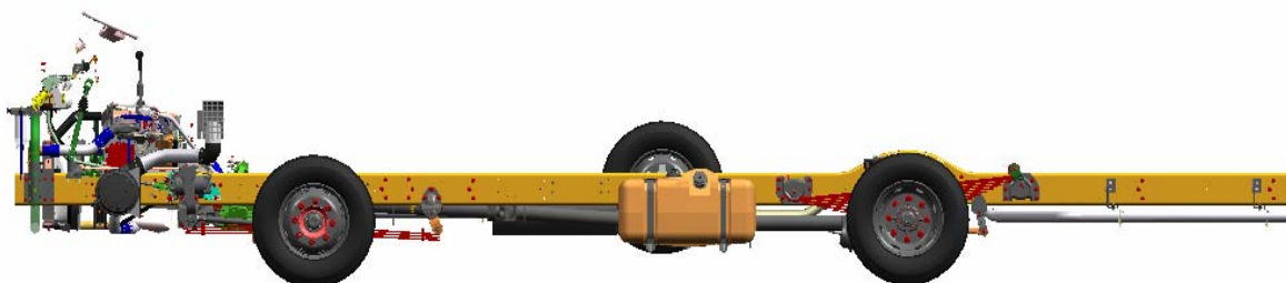
Figura 2.6 – Veículo motor à frente do eixo dianteiro e tração traseira (Fonte: Projeto restrito de identificação)
