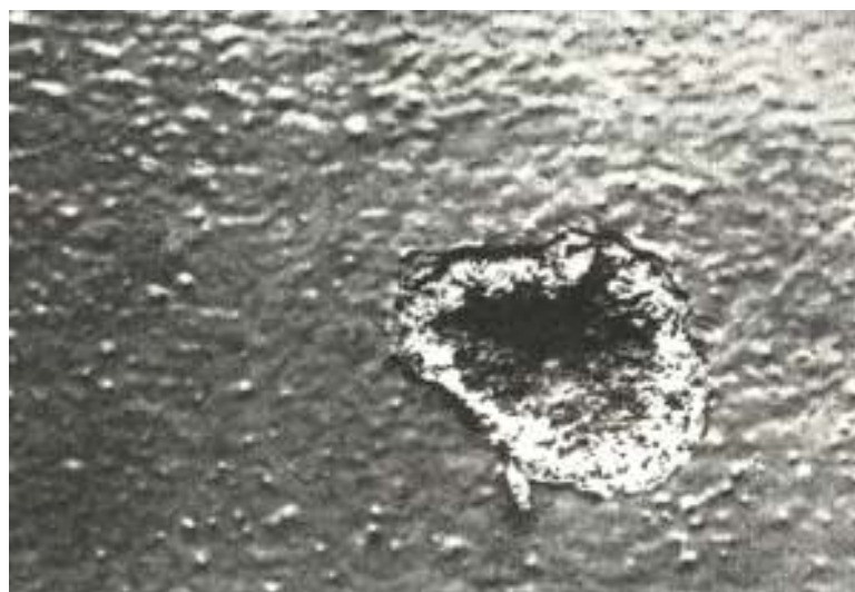
Figura 9: vesícula no revestimento em argamassa resultante de hidratação retardada de óxidos presentes na cal (THOMAZ, 1989)
