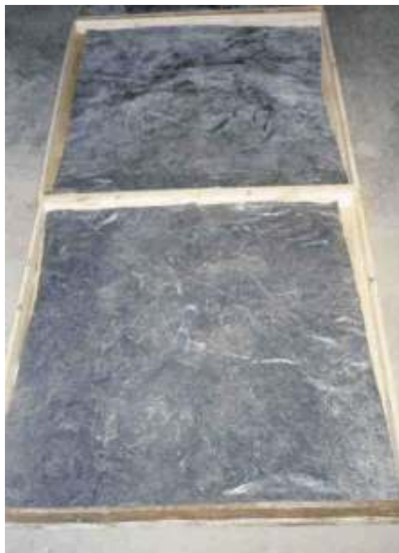
Figura 35: forma de madeira utilizada para moldagem dos corpos-de-prova
