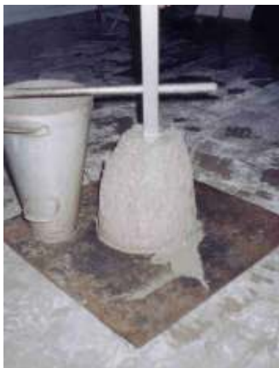
Figura 33: ensaio de abatimento do tronco de cone
