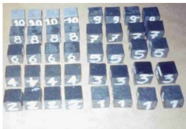
Figura 49: corpos-de-prova para ensaio de desgaste por abrasão pela CIENTEC
