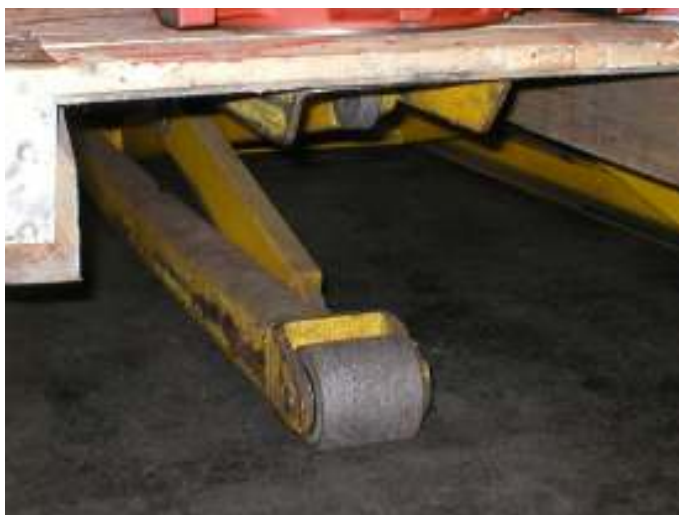
Figura 28: detalhe da roda metálica utilizada em alguns equipamentos industriais que favorecem ao desgaste a abrasão da superfície de pisos
