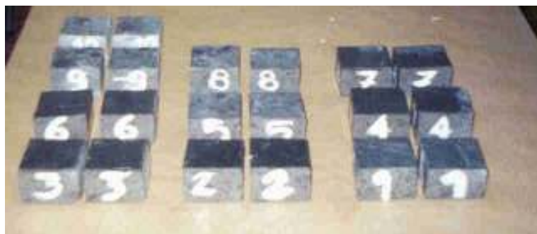
Figura 48: corpos-de-prova para ensaio conforme NBR 12.042 (ABNT, 1992)
