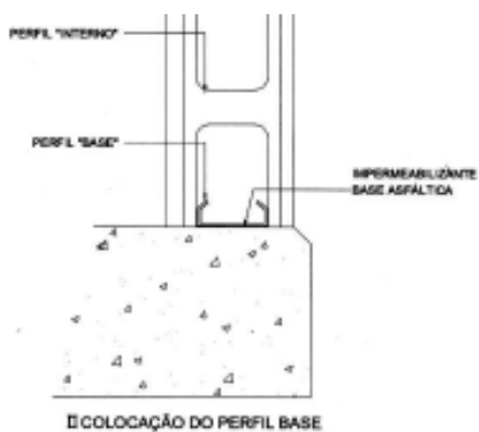
Figura 43: Representação esquemática do perfil base (SISTEMA A, 2002)
