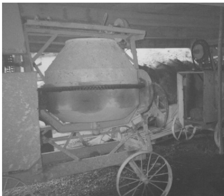
Figura 35: betoneira utilizada na obra 1
