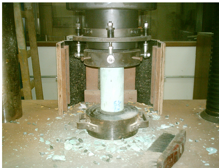
Figura 26: Ensaio de resistência à compressão
