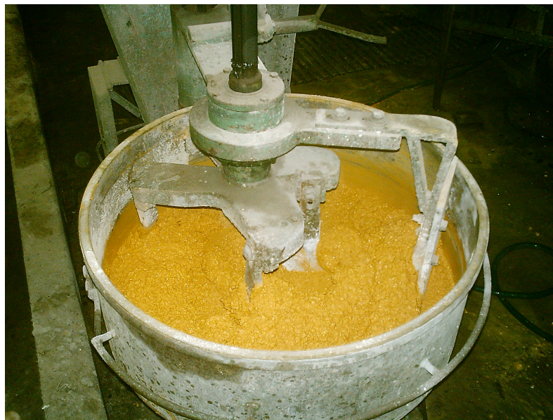
Figura 22: Mistura de concreto pigmentado “A” amarelo
