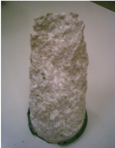
Figura 27: Corpo de prova testemunho
