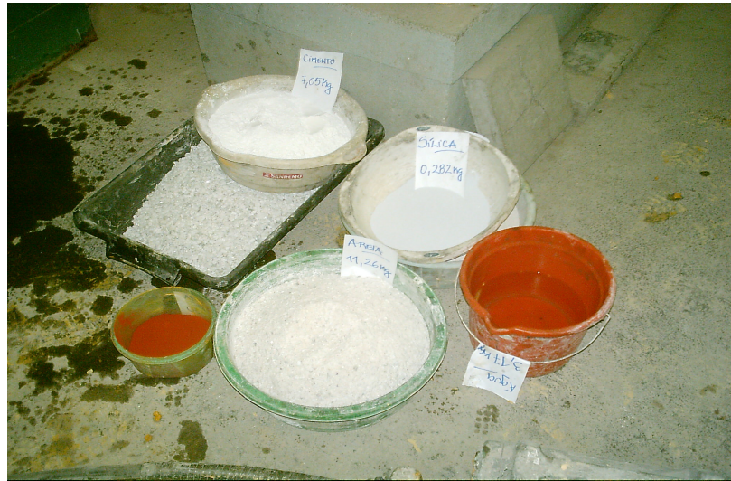
Figura 20: Materiais Utilizados para a concretagem
