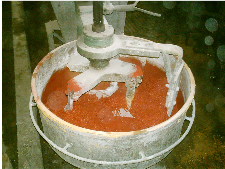
Figura 21: Mistura de concreto, pigmento “A” Vermelho
