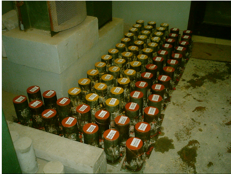
Figura 23:Corpos-de-prova após concretagem
