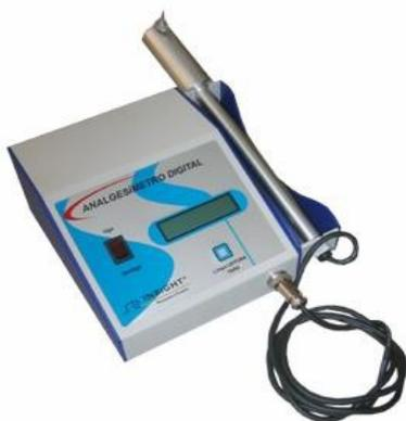
**Figura 6:** Analgesímetro digital, modelo EFF 301, da Insight, Brazil, utilizado na realização do teste de Von Frey eletrônico.
