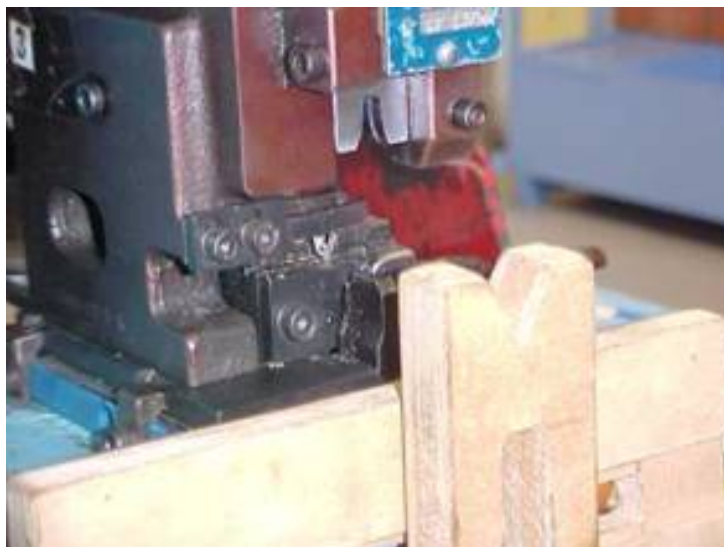
Figura 32 - Dispositivo de posição para a grimpagem dos chicotes
