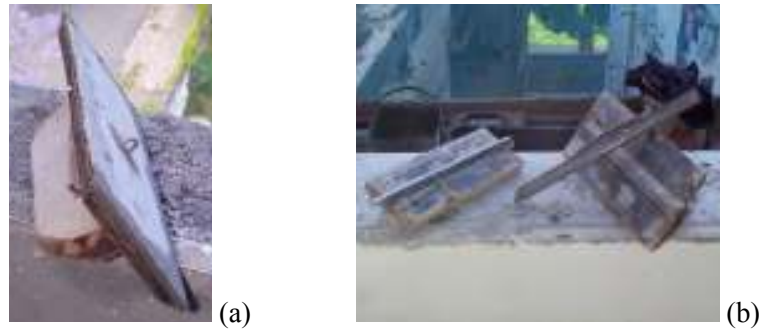
Figura 77: Ferramentas usadas pelos pedreiros para execução de frisos
