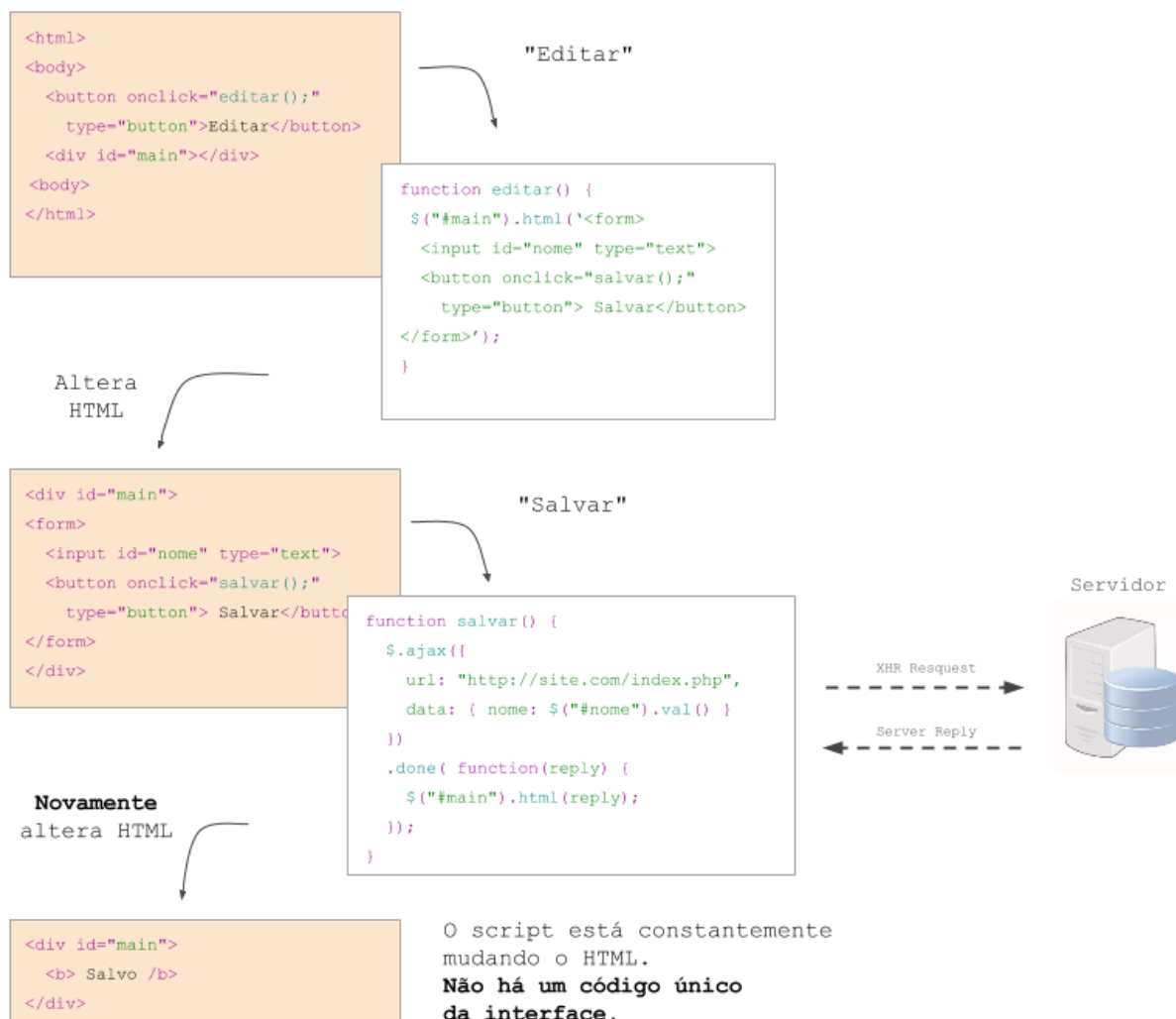
Figura 16 - JQuery se comunicando com o servidor e modificando o HTML.
