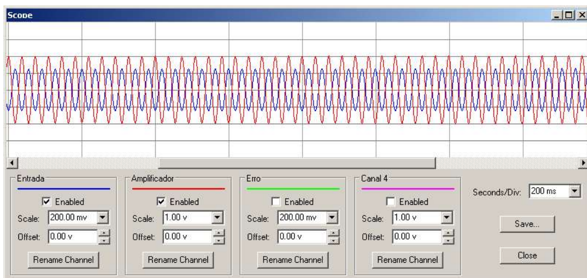
Figura 41 – Oscilador com ganho unitário para 180°
