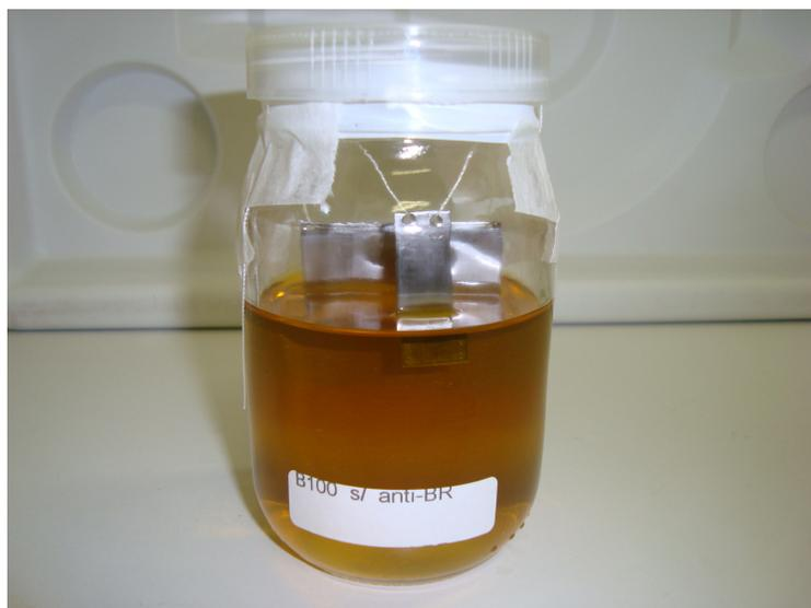
**Figura 4. Armazenamento do Biodiesel, utilizando vidros transparentes, em contato com chapas de aço inoxidável.**
