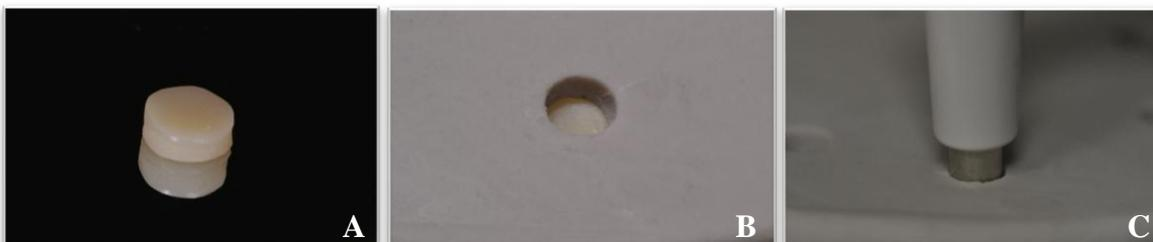
Figura 3. A-C - (A) Espécime de resina composta (B) Espécime no interior do orifício da matriz de silicóna de condensação (C) Colocação da ponteira do espectrofotômetro sobre o espécime no interior da matriz de silicóna.
