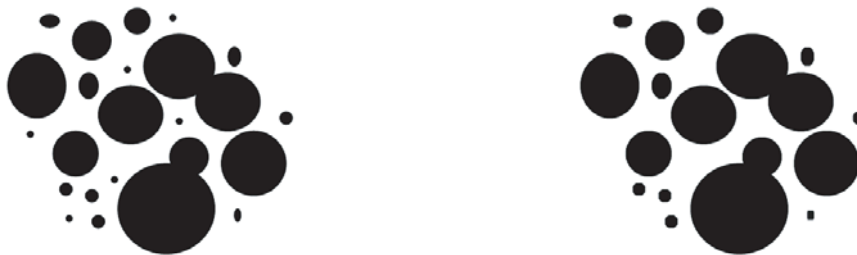
Figura 2.6: Imagem original e imagem resultante da abertura binária pelo elemento estruturante do tipo caixa de tamanho 7x7.
