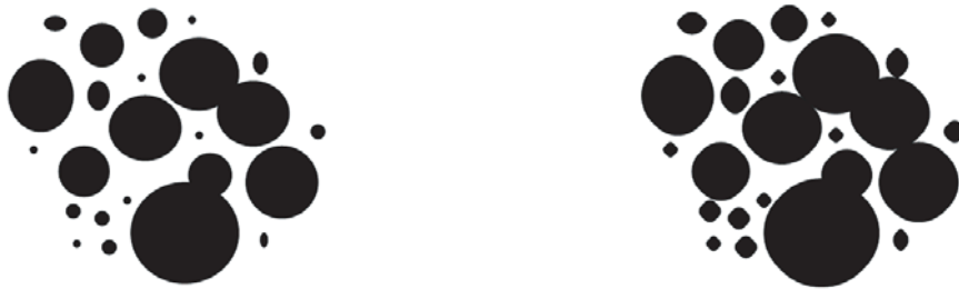
Figura 2.4: Imagem original e imagem resultante da dilatação binária pelo elemento estruturante do tipo diamante de tamanho 9 \times 9 .
