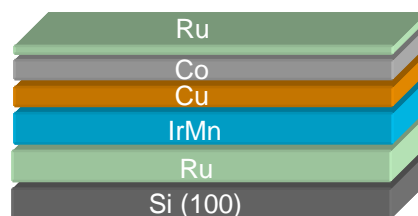
Figura 3.1 : Figura esquemática da amostra Si(100)/Ru(15 nm)/IrMn(15 nm)/Cu ( t_{Cu} )/Co(5 nm)/Ru(30 nm), t_{Cu} = 0, 0.25, 0.5, 0.75, 1, 1.5, 2, 3, 5 nm.
