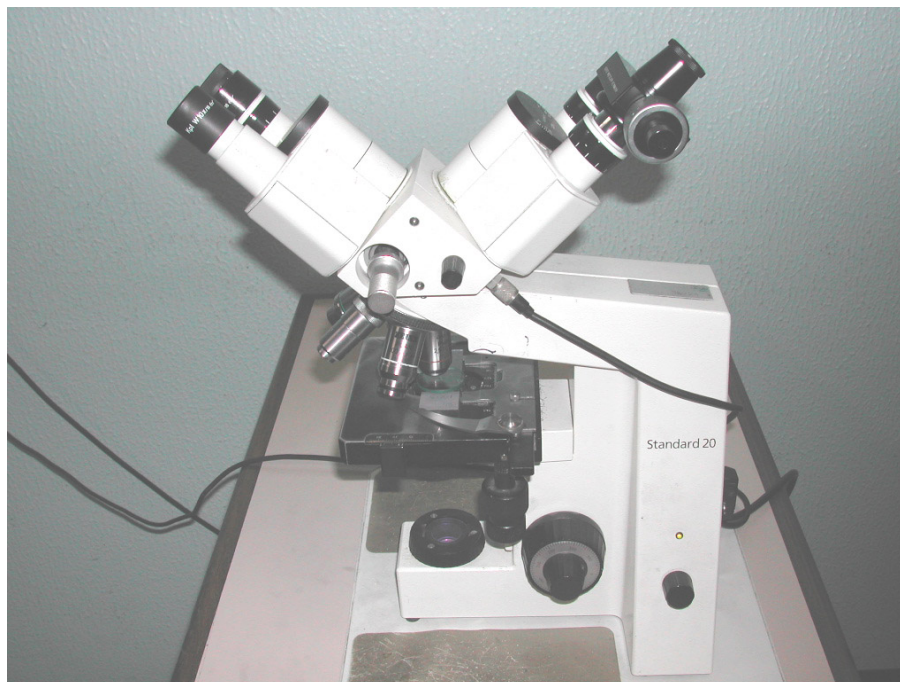
Figura 3: Microscópio óptico de dupla observação com o retículo de medida ocular inserido em uma das oculares.
