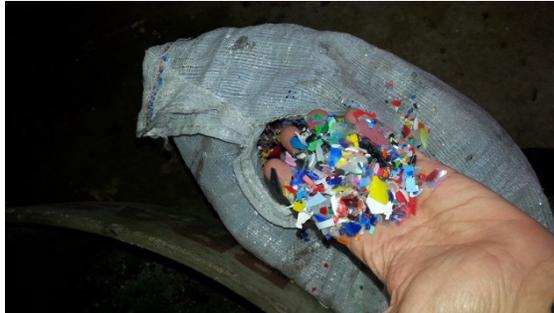
Figura 34 – Flakes de polipropileno obtidos no processo de beneficiamento do resíduo plástico na cooperativa da cidade de Dois Irmãos.
