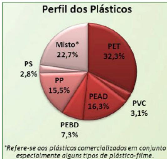
Figura 16 – Perfil dos plásticos reciclados [21].
