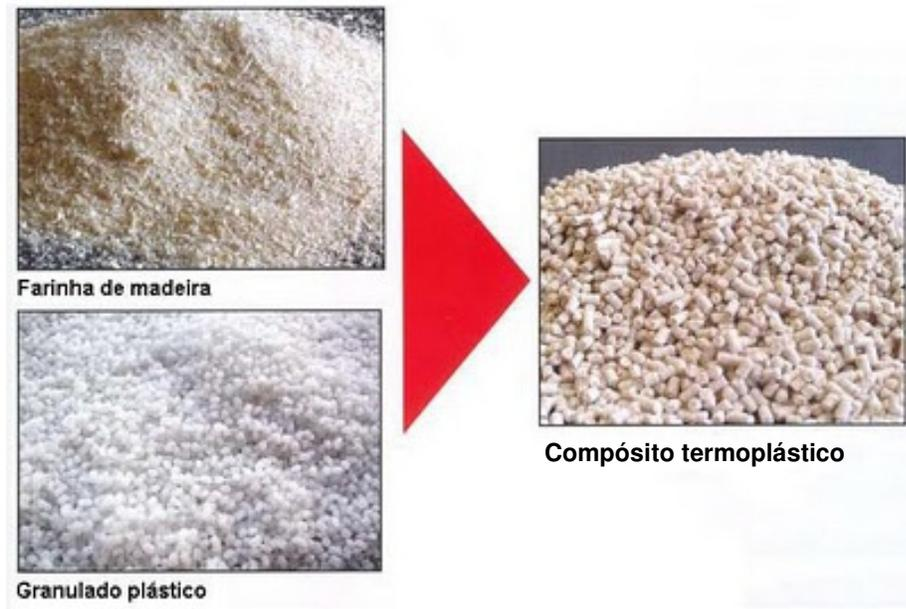
Figura 40 – Ilustração dos componentes para a produção da mistura da madeira plástica na forma de grânulos [41].
