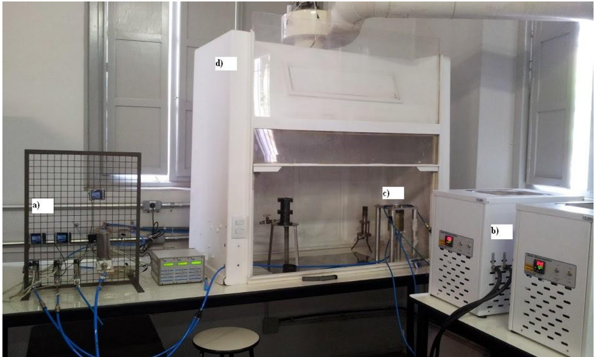
Figura A.1 - Fotografia da bancada de trabalho evidenciando (a) os controladores/medidores de vazão, (b) os banhos termostáticos, (c) o queimador e a base de apoio (c) e (d) a capela que compõem a bancada
