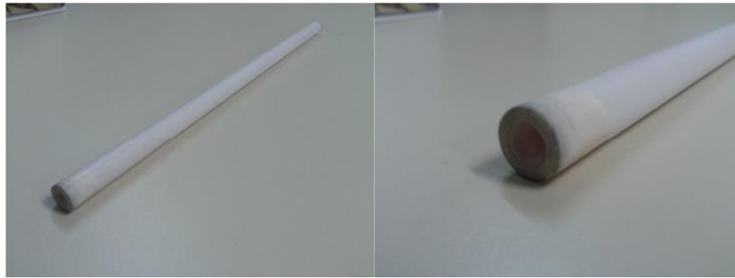
**Figura 4.5.** Fotografia da membrana cerâmica tubular de MF.
