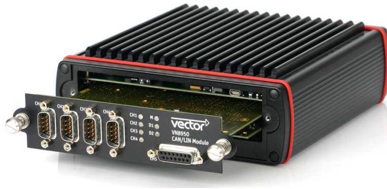
Figura 37: Foto da unidade base VN8910A com módulo VN8950 (VECTOR INFORMATIK GMBH, 2013b).
