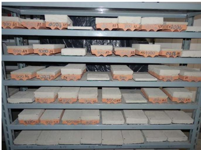
Figura 28: vista geral dos corpos de prova mantidos em cura
