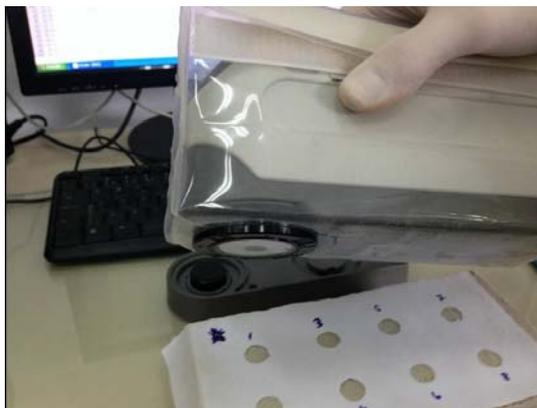
Figura 29: posicionamento do gabarito sobre a argamassa e detalhe anterior às leituras com espectrofotômetro
