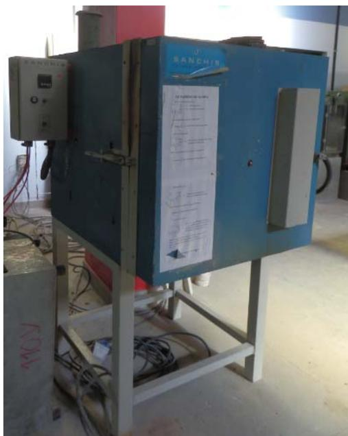
Figura 20: aspecto da mufla utilizada no processo de queima dos substratos cerâmicos
