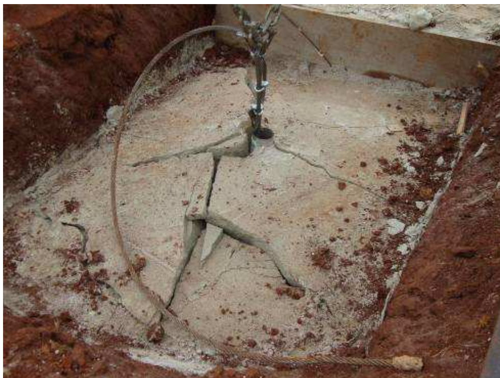
Figura 4.30: Ruptura no ensaio de areia-cimento com embutimento H/D = 2,0 .
