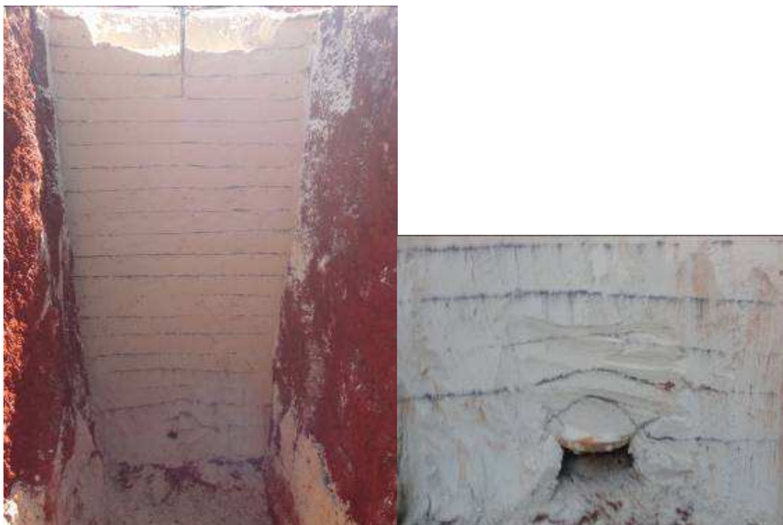
Figura 4.51: Exumação do ensaio em areia – H/D 10,0.
