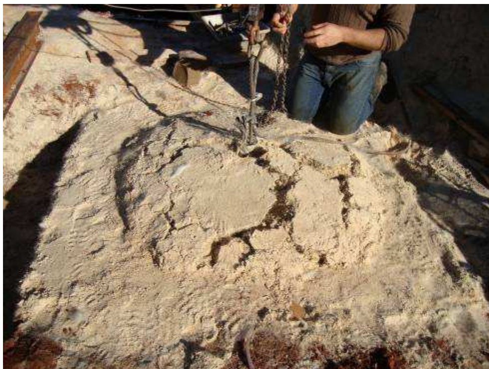
Figura 4.27: Ruptura no ensaio de areia-fibra com embutimento H/D = 2,0 .
