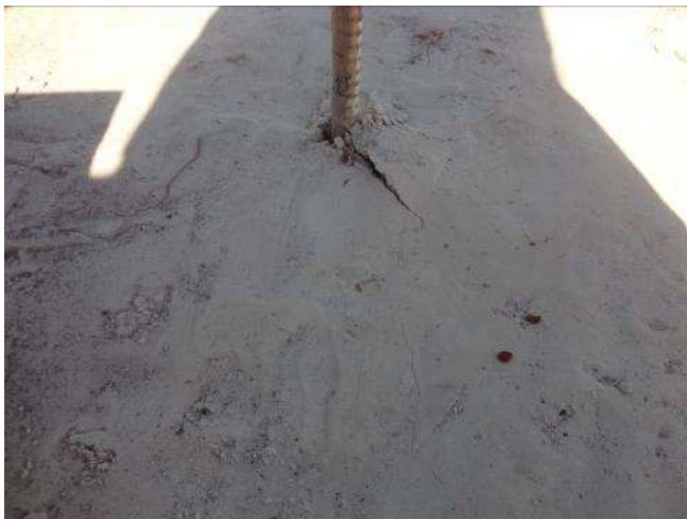
Figura 4.45: Ruptura no ensaio de areia com embutimento H/D = 10,0 .
