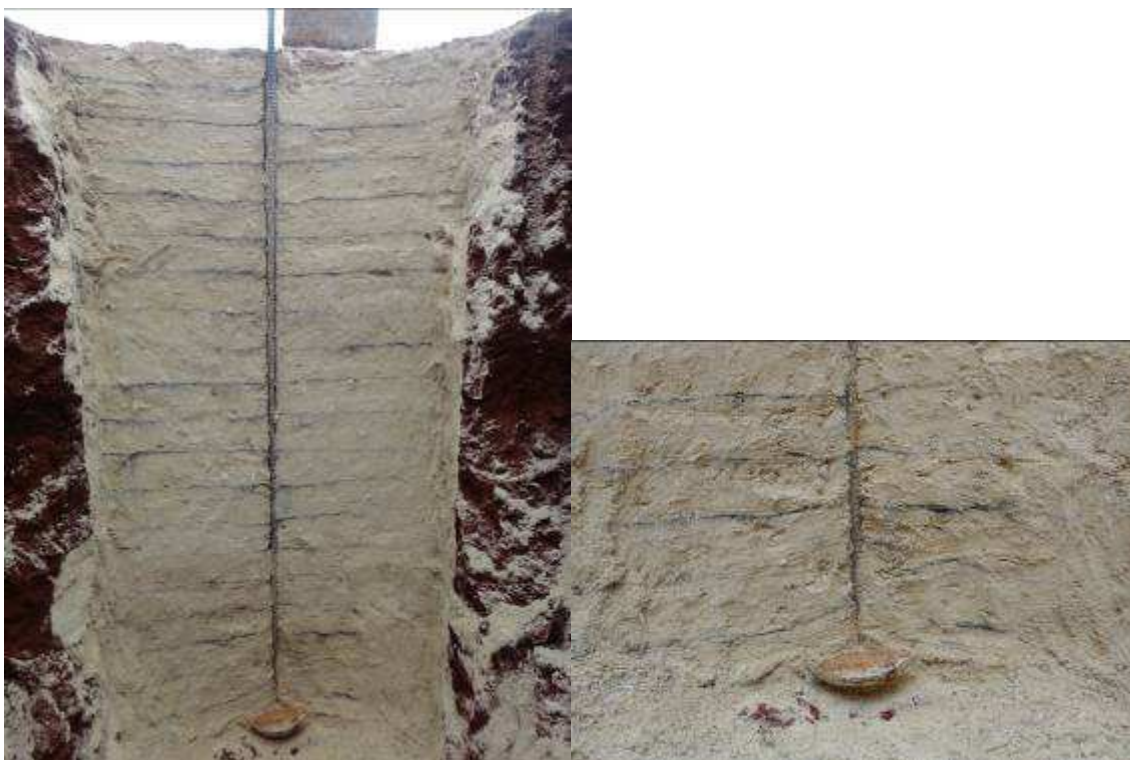
Figura 4.54: Exumação do ensaio em areia-fibra – H/D 10,0.
