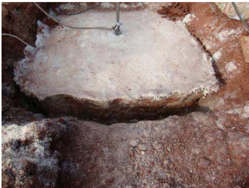
Figura 4.33: Ruptura no ensaio de areia-cimento-fibra com embutimento H/D = 2,0 .
