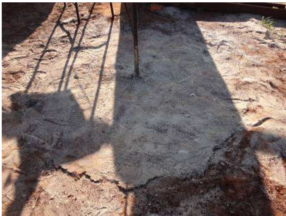
Figura 4.48: Ruptura no ensaio de areia-fibra com embutimento H/D = 10,0 .
