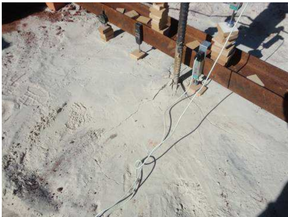
Figura 4.44: Ruptura no ensaio de areia com embutimento H/D = 7,0 .
