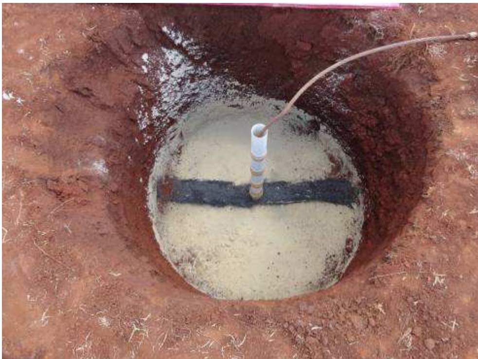
Figura 3.15: Colocação de areia tingida de preto para identificação da deformação das camadas na exumação dos ensaios.
