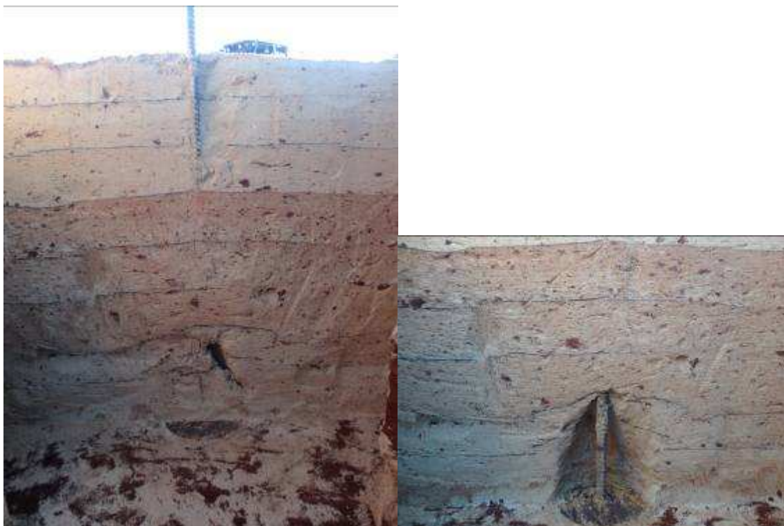
Figura 4.49: Exumação do ensaio em areia – H/D 4,0.
