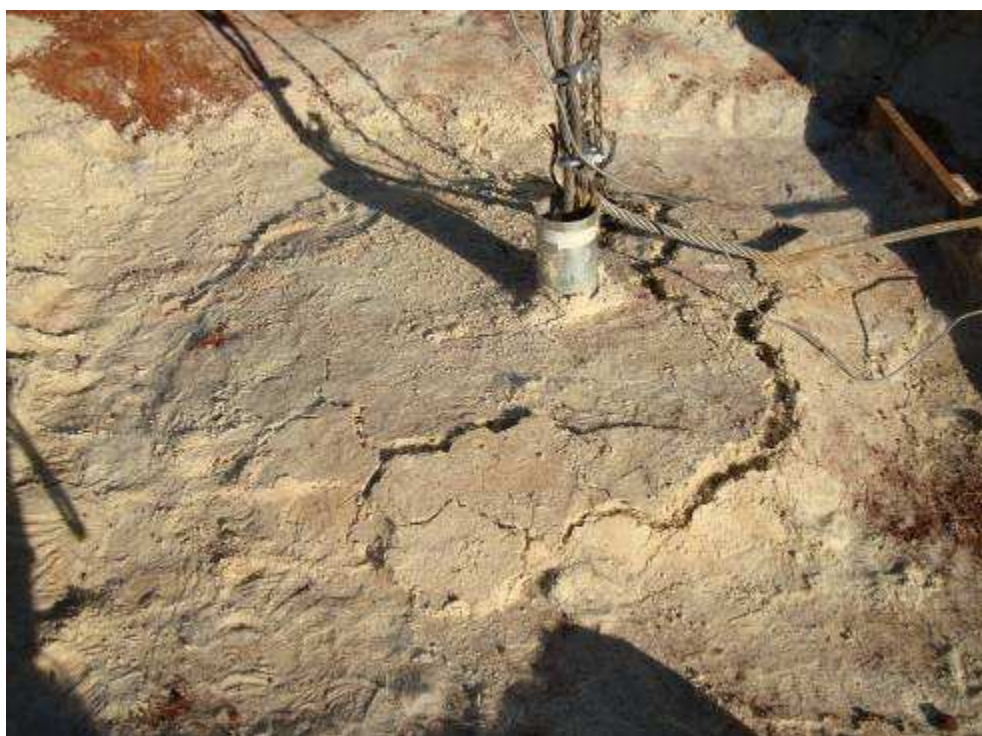
Figura 4.26: Ruptura no ensaio de areia-fibra com embutimento H/D = 1,5 .
