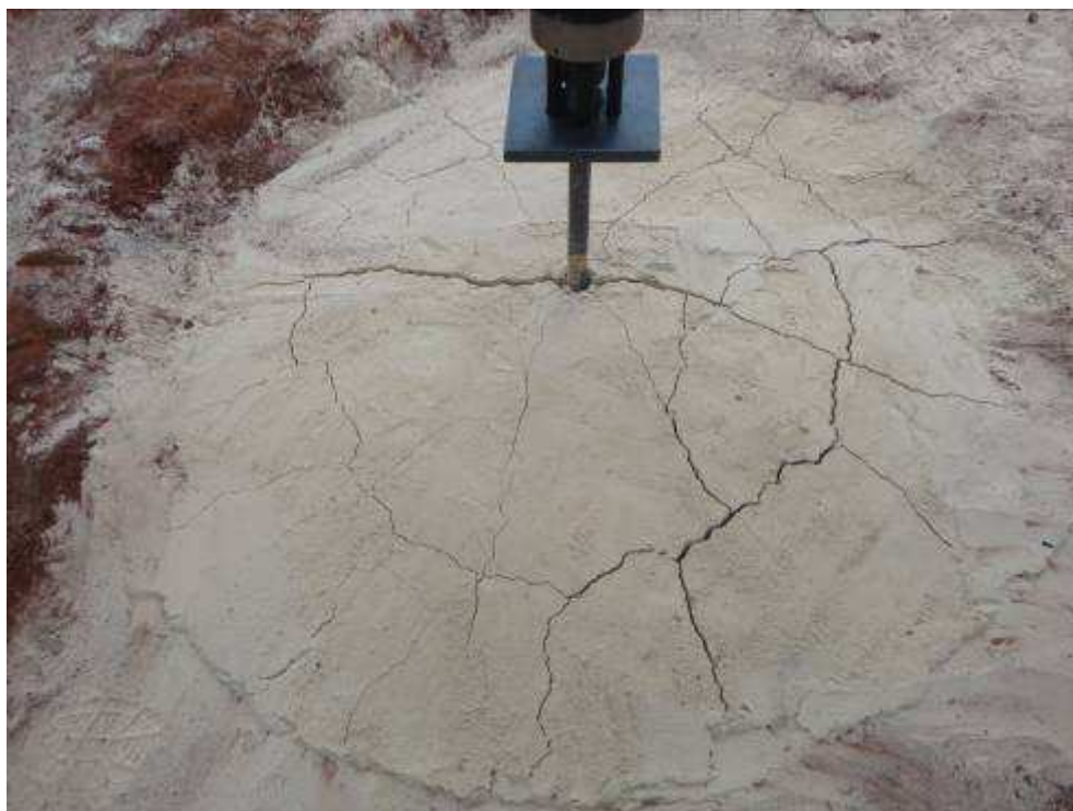
Figura 4.43: Ruptura no ensaio de areia com embutimento H/D = 4,0 .
