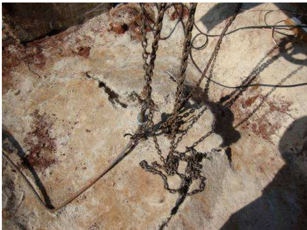
Figura 4.31: Ruptura no ensaio de areia-cimento-fibra com embutimento H/D = 1,0 .
