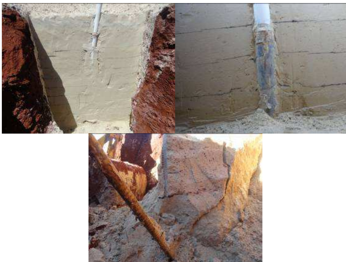
Figura 4.50: Exumação do ensaio em areia – H/D 7,0.
