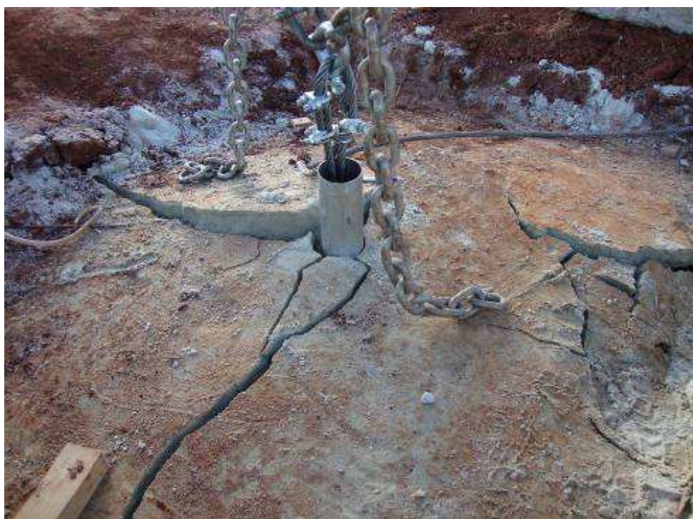
Figura 4.29: Ruptura no ensaio de areia-cimento com embutimento H/D = 1,5 .
