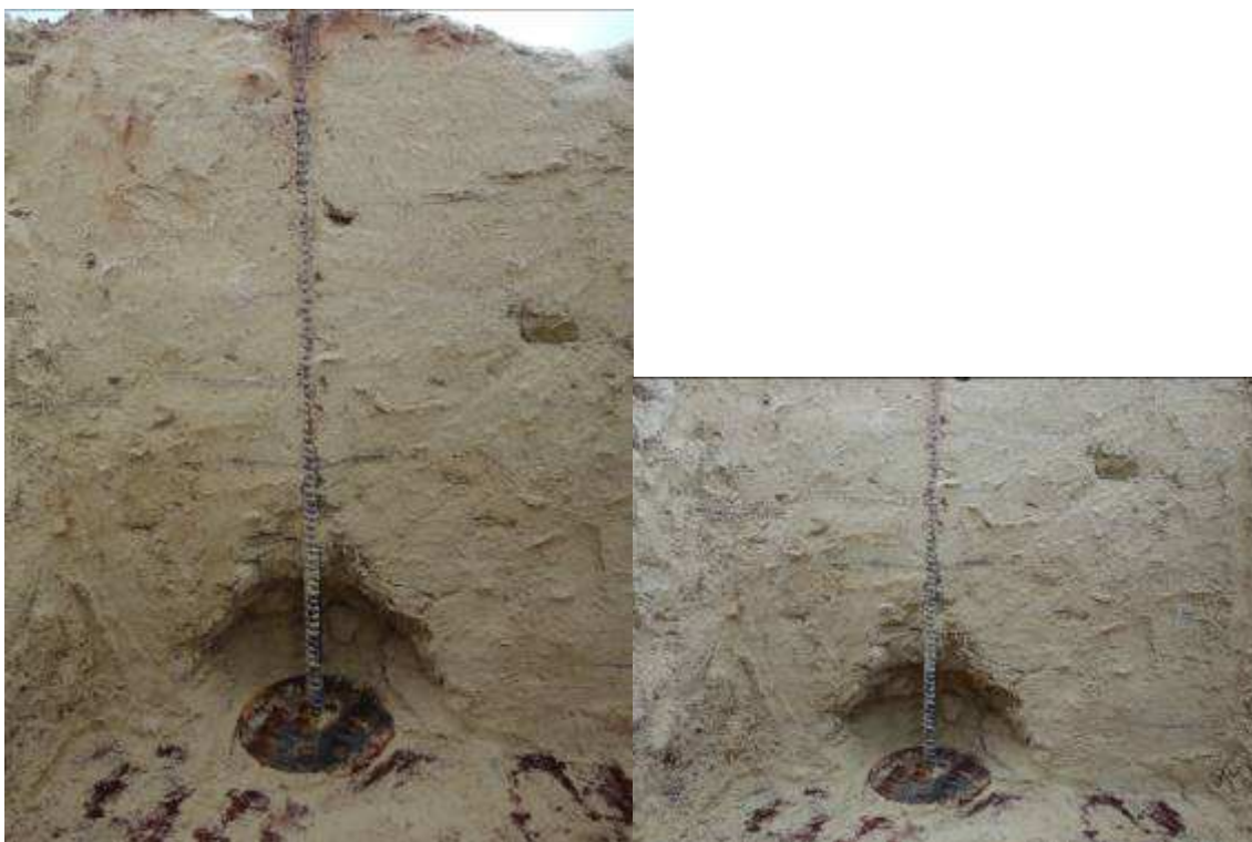
Figura 4.52: Exumação do ensaio em areia-fibra – H/D 4,0.
