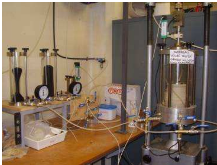
Figura 3.6: Equipamento triaxial utilizado nos ensaios.
