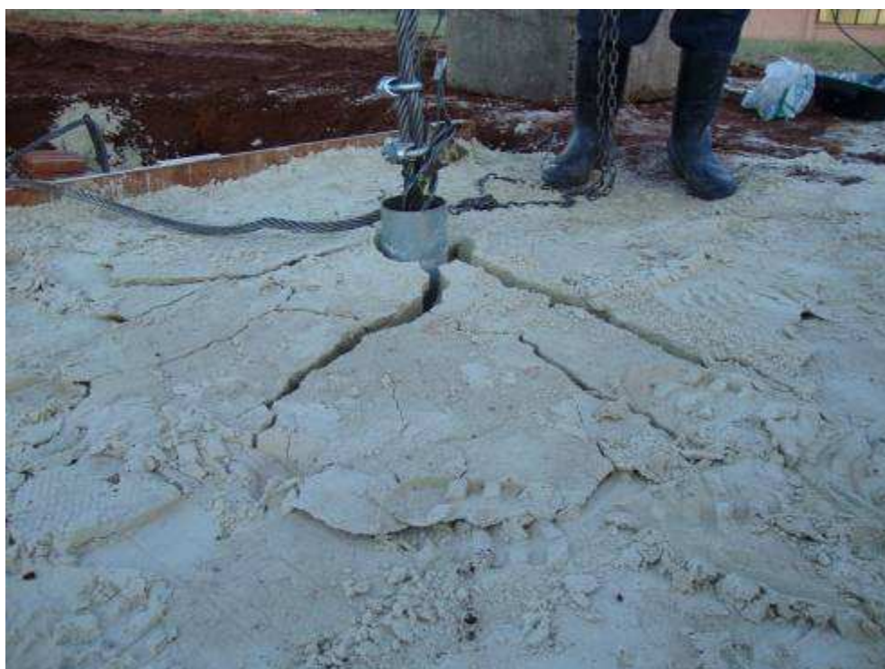
Figura 4.24: Ruptura no ensaio de areia com embutimento H/D = 2,0 .
