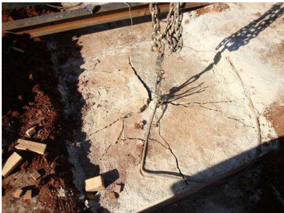
Figura 4.28: Ruptura no ensaio de areia-cimento com embutimento H/D = 1,0 .
