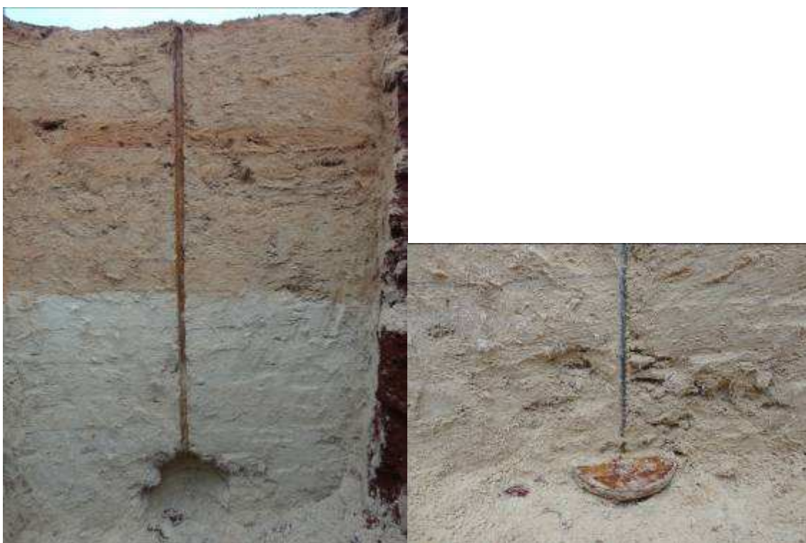
Figura 4.53: Exumação do ensaio em areia-fibra – H/D 7,0.
