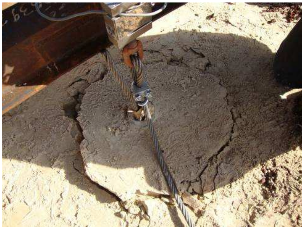
Figura 4.22: Ruptura no ensaio de areia com embutimento H/D = 1,0 .
