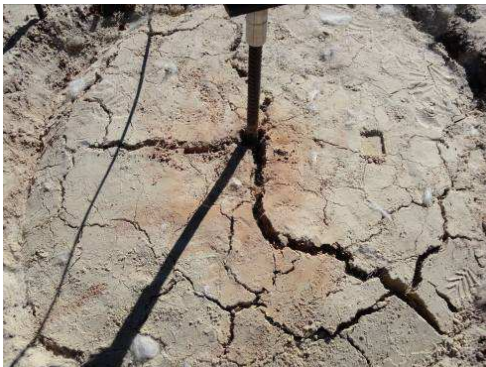
Figura 4.46: Ruptura no ensaio de areia-fibra com embutimento H/D = 4,0 .
