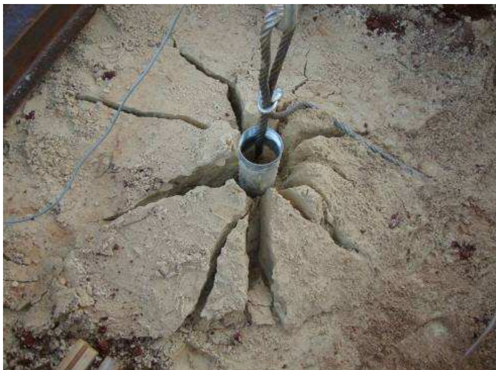
Figura 4.23: Ruptura no ensaio de areia com embutimento H/D = 1,5 .
