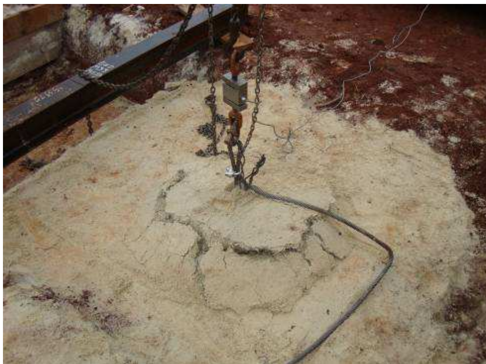
Figura 4.25: Ruptura no ensaio de areia-fibra com embutimento H/D = 1,0 .
