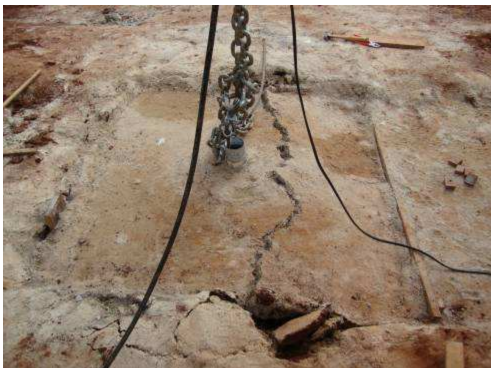
Figura 4.32: Ruptura no ensaio de areia-cimento-fibra com embutimento H/D = 1,5 .
