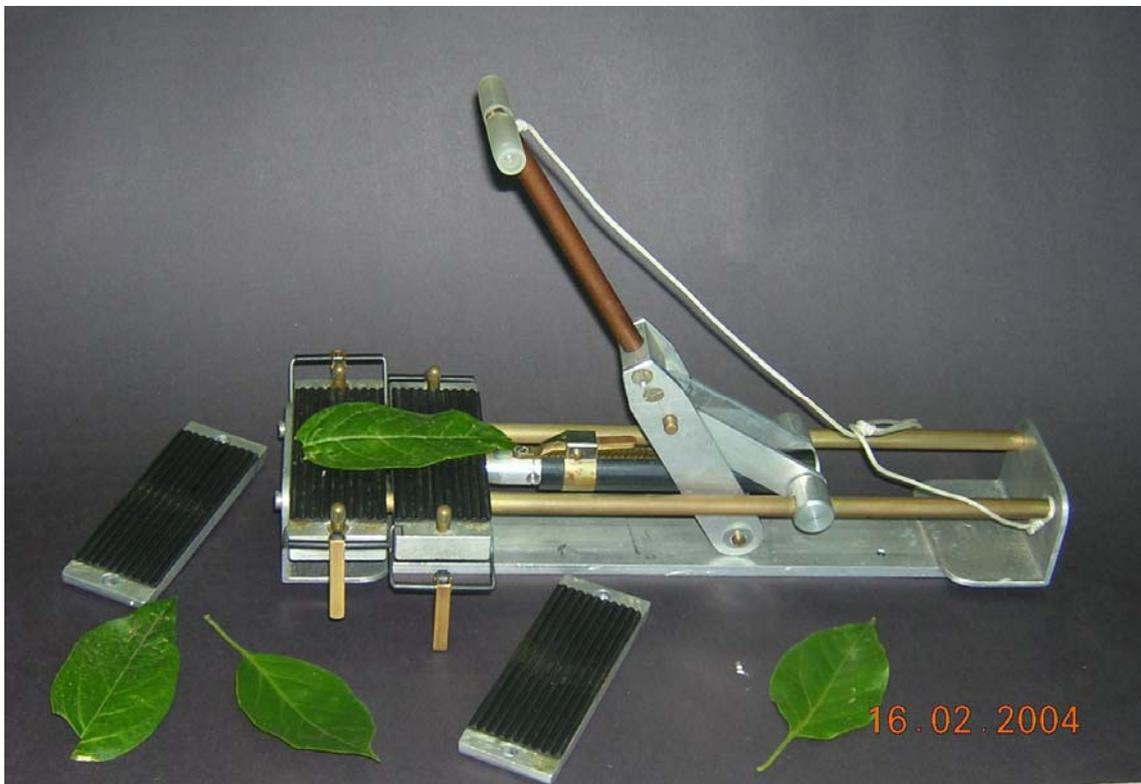
FIGURA 4. Dinamômetro adaptado de Grime, Coper e Taskes (1993).
