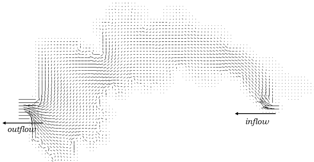
FIGURA 7.34 - Campo de velocidades, onde |U|=0,3 m/s na fronteira outflow e |U|=0,9 m/s na fronteira inflow . Os parâmetros usados no modelo hidrodinâmico (ESW 2D-IV) foram \eta_0 = 0,20 m, \Omega = 7,27 \cdot 10^{-5} m 2 /s, C_D = 3,0 \cdot 10^{-6} , W_{x,y} = 6,0 m/s 2 , C_z = 65,0 e \varepsilon_h = 10,0 m 2 /s
