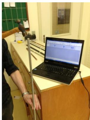
**Figura B.25** - Barra metálica sendo segurada na metade do comprimento e sendo percutida com o martelo na extremidade superior.
