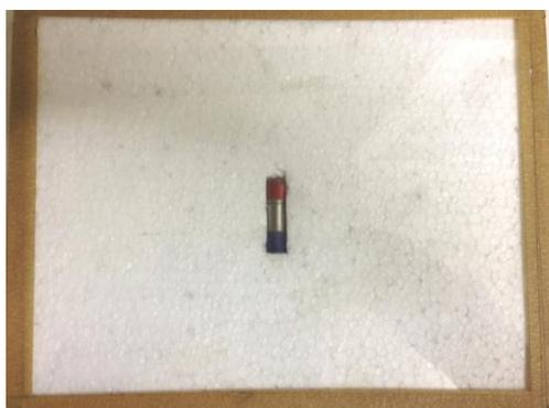
**Figura B.33** – Imagem de um ímã com formato de barra cilíndrica. As cores azul e vermelha representam os polos Sul e Norte do ímã.
