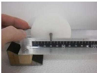
**Figura B.2** - Aluno posicionando o rolete na extremidade superior do trilho e liberando o mesmo para dar início ao movimento.
