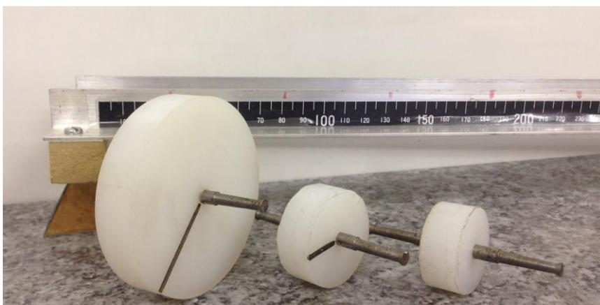
**Figura A.2** - Kit experimental para o estudo de movimentos retilíneos com aceleração constante: trilho (haste metálica com duas canaletas), roletes e calço de madeira.
