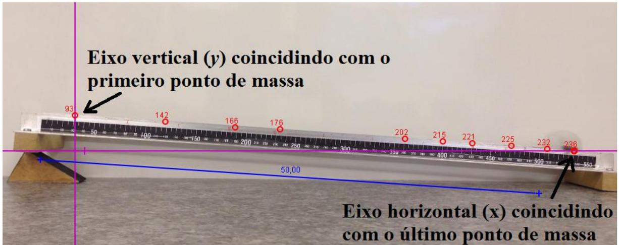
**Figura B.13** - Sistema de eixos coordenados (x) e (y) na direção horizontal e vertical.
