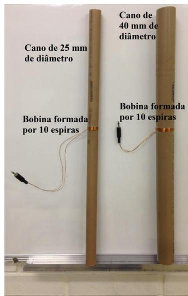
**Figura B.46** – Dispositivo 2. Imagem das bobinas formadas nos canos de 25 e 40 mm de diâmetro. As duas bobinas possuem 10 espiras e estão localizadas na mesma posição.
