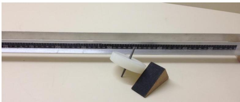
**Figura B.1** – Kit experimental para o estudo do movimento retilíneo uniformemente variado: rolete, calço de madeira e trilho (haste metálica com duas canaletas).
