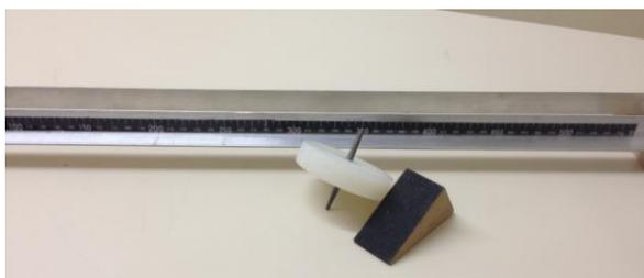
**Figura A.1** - Kit experimental para o estudo de movimentos retilíneos com aceleração constante: trilho (haste metálica com duas canaletas), rolete, calço de madeira.
