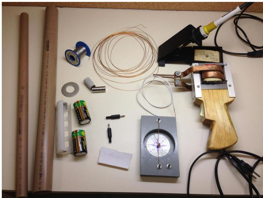
**Figura B.31** - Materiais (ferro de soldar, estanho, fio de 1,5 mm<sup>2</sup>, fio de 2,5 mm<sup>2</sup>, ímãs em formato de pastilhas 18 x 2 mm, tampa de caneta, canos de PVC, arruela de ferro, *plug* P2 mono, lixa, bússola, suporte para pilhas e pilhas).
