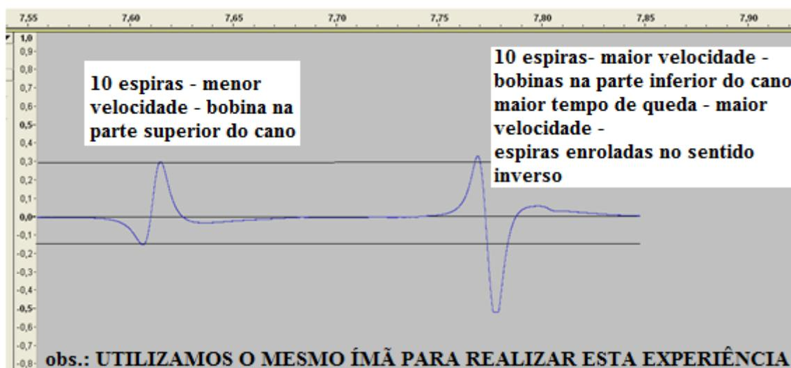
**Figura 5.56** – Imagem da análise apresentada pelo Grupo C. A figura foi elaborada a partir do sinal capturado pelo *software* Audacity. A análise mostra que a intensidade da corrente induzida depende da rapidez da variação do fluxo magnético.
