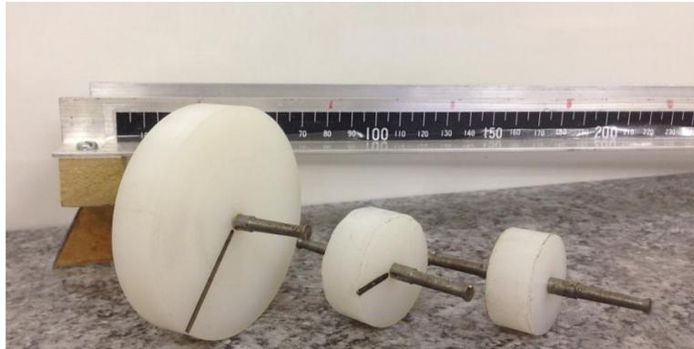
**Figura B.7** - Kit experimental para o estudo do movimento retilíneo uniformemente variado: trilho (haste metálica com duas canaletas), roletes formados por discos diferentes soldados em eixos idênticos e calço de madeira.
