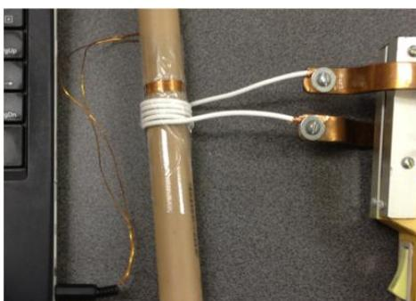
**Figura B.48** – Dispositivo 4. Imagem da montagem do experimento para determinar a frequência da rede elétrica. Na imagem temos: o fio de 2,5 mm<sup>2</sup> conectado ao ferro de soldar formando uma bobina no cano de 25 mm de diâmetro. O cano possui outra bobina formada por 10 espiras que esta conectada na entrada de áudio do computador através do *plug* P2.
