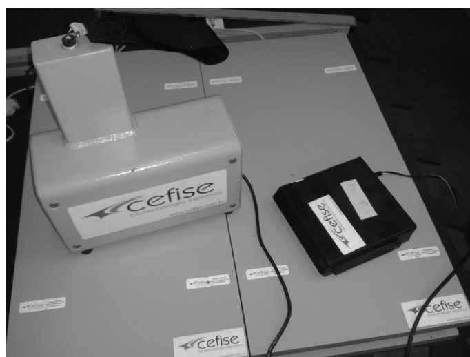
Figura 9. Equipamento para aquisição da potência média de extensores de joelho.
