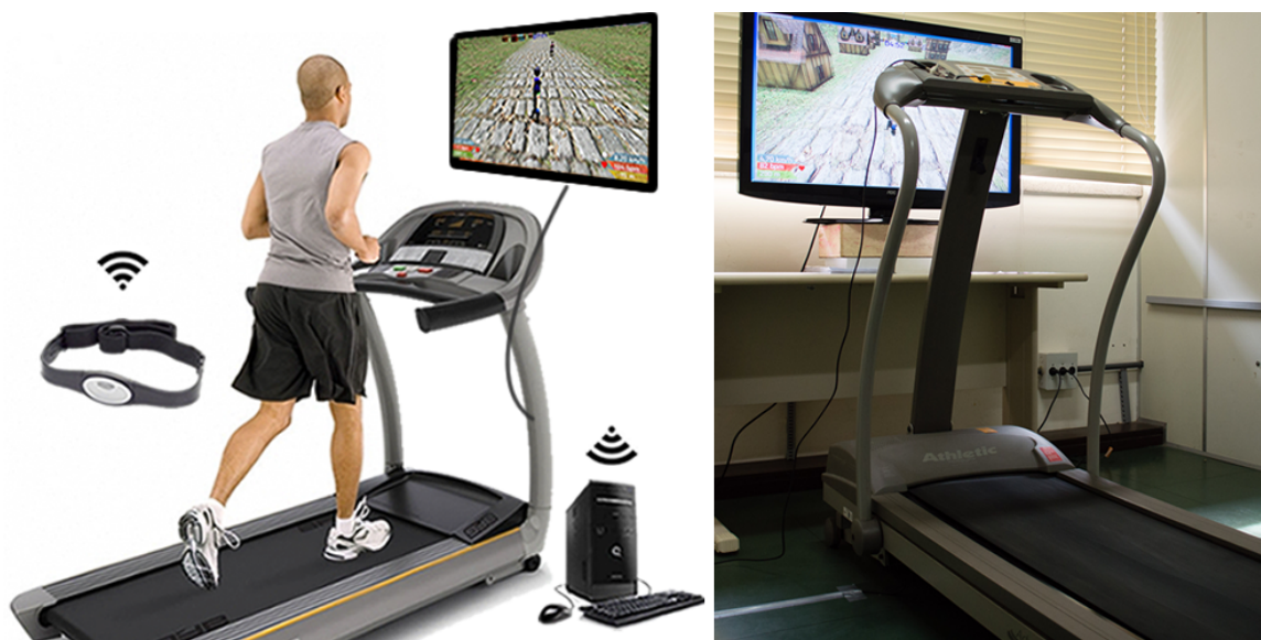
Figura 4.1 – À esquerda, modelo conceitual do sistema: esteira ergométrica, sensores de velocidade e frequência cardíaca, e PC para processamento e geração do ambiente virtual; à direita, Running Wheel em funcionamento
