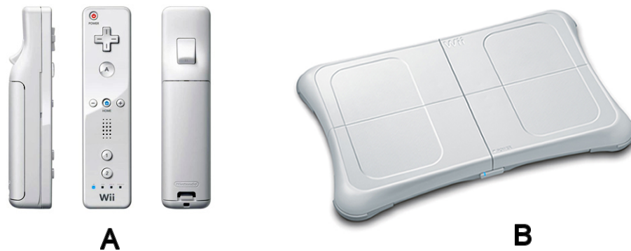
Figura 2.3 – Controles do Nintendo Wii: a) Wiimote em três pontos de vista: lateral, frontal e posterior; e b) Balance Board
