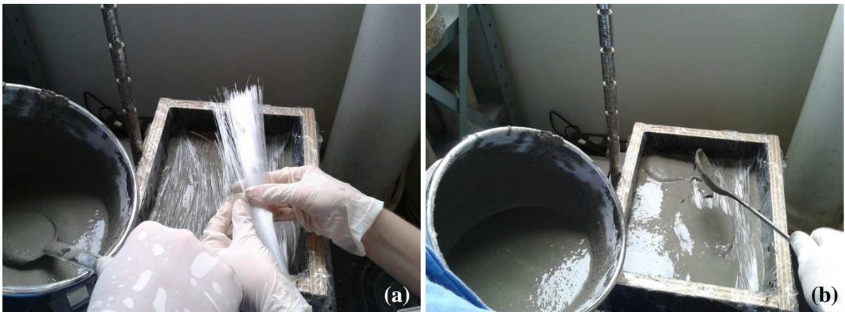
No dia posterior de cada uma das quatro moldagens (0%, 2%, 3,5% , 5% de FOP) foram feitas as desfôrmas dos blocos e conseqüentemente o corte através de serra (Figura 48). A partir de cada grande bloco foram gerados 5 CP’s prismáticos (4x4x16cm).
