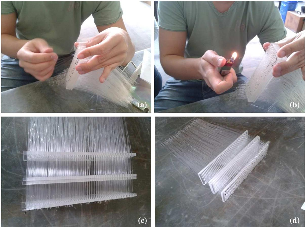
Como já dito anteriormente, este método de produção com fibras dispostas equidistantes entre si busca a sua melhor distribuição possível nos corpos de prova. Com uma boa organização, sem o acúmulo ou falta de FOP em determinados pontos, busca-se avaliar através de ensaios um experimento com a menor variabilidade experimental possível nos resultados.
