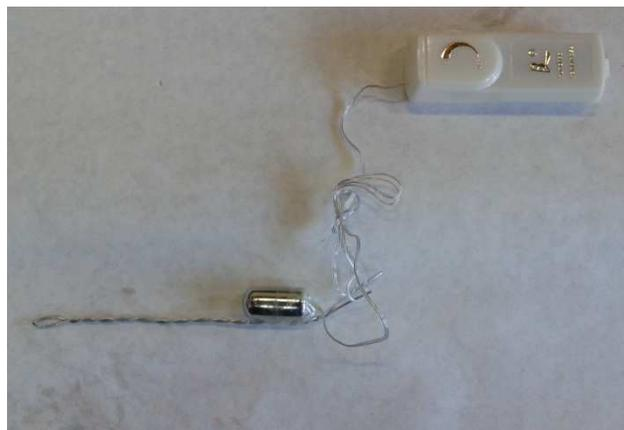
Testes anteriores feitos com o mesmo molde, mas utilizando mesas vibratórias, não se mostraram tão eficientes quanto ao vibrador de imersão. Quando todo o sistema (fôrma, argamassa e fibras) foi vibrado, em muitos casos houve perda de pasta/argamassa por danos
