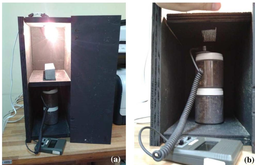
O luxímetro utilizado para medir iluminância é um aparelho formado por um sensor fotométrico conectado a um mostrador digital. O modelo utilizado é do fabricante Lutron, modelo LX-101 LUX METER. O equipamento de medição utilizado pesquisa pertence ao LabCon (Laboratório de Conforto Ambiental) da UFRGS.
