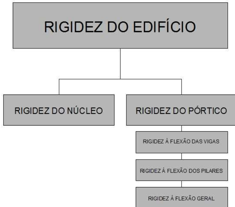
Figura 3.4: Esquema do modelo de rigidez proposto (fonte: elaborado pelo autor).
