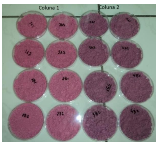
Figura 4.6: Amostras dos pós obtidos por atomização com maltodextrina (coluna 1) e goma arábica (coluna 2) anteriormente aos testes.
