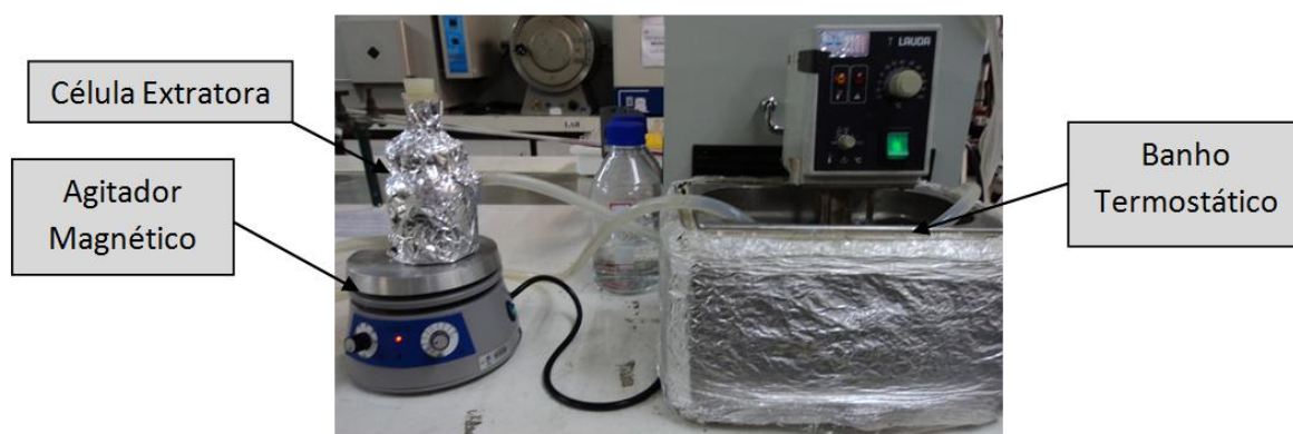
Figura 3.2: Aparato para extração de antocianinas do bagaço de mirtilo.
