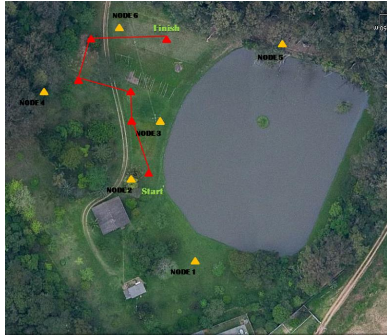
Figura 24 Área com distribuição dos nós de referência e caminho percorrido pelo objeto alvo para o experimento 2.
