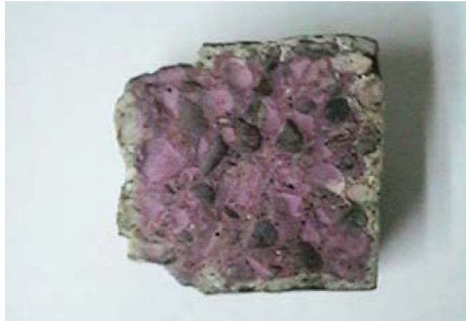
Figura 38 – Muestra de hormigón a la que se ha aplicado la técnica de la fenolftaleína (OCAMPO et al. 2005)
